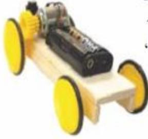
نجد في الأسواق بعض الألعاب (سيارات الأطفال)، التي يمكن التحكم في حركتها عن طريق مفتاحين منفصلين أو مفتاح مزدوج، تتحكم في اتجاه دوران المحرك، الشكل (١٧). يستخدم المحرك لإنتاج حركة دورانية باتجاهين، حسب قطبية البطارية الموصول بها، انظر الشكل (١٨)، في أي اتجاه يتحرك المحرك؟
